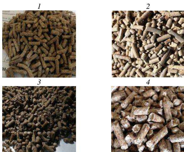
**Рис. 3.** Гранулы, сформованные с использованием различных связующих: 1 – опилки и стеарин; 2 – опилки и жидкое стекло; 3 – опилки и суспензия картона; 4 – опилки и лигнин
