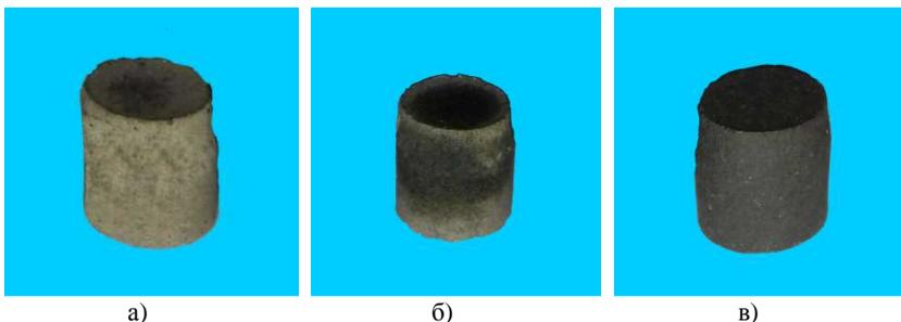
**Рис. 1.** Внешний вид образцов клинкера, полученных раздельным вводом при температуре обжига: а) 1250°C; б) 1275°C; в) 1300°C
