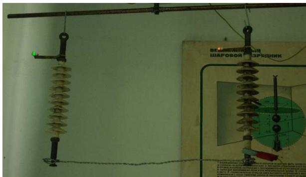
**Рис. 3.** Изображение дефектного и исправного полимерных изоляторов с установленными на них светодиодными индикаторами
