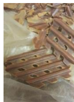
Рис.2.Отложение на пластинчатом водонагревателе
