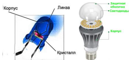
Рис. 3. Светодиод и светодиодная лампа
