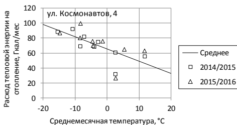
Рис. 4. График месячной отопительной нагрузки
