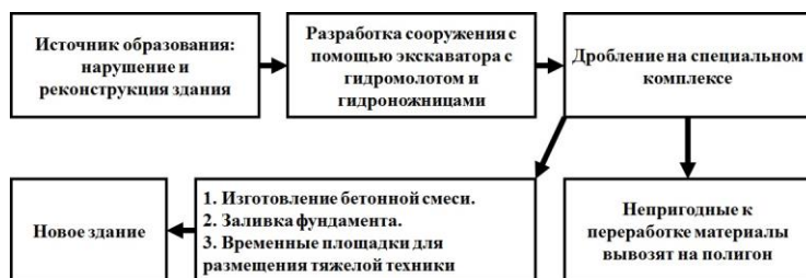
Рис. 4. Схема обращения с отходами бетона
