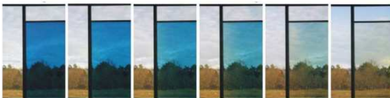
Рис. 2. Режимы электрохромного многослойного стекла
