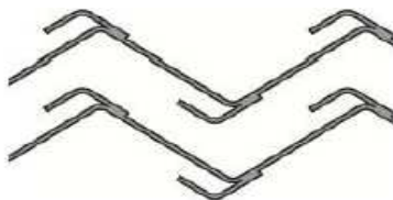
Рис. 2. Элемент сепаратора с дренажными каналами
