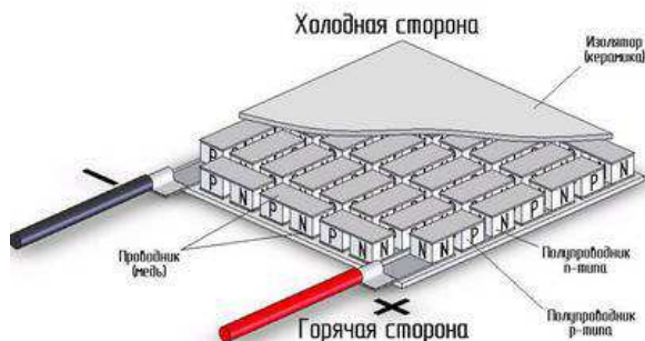
Рис.1. Устройство термоэлектрического генератора.
