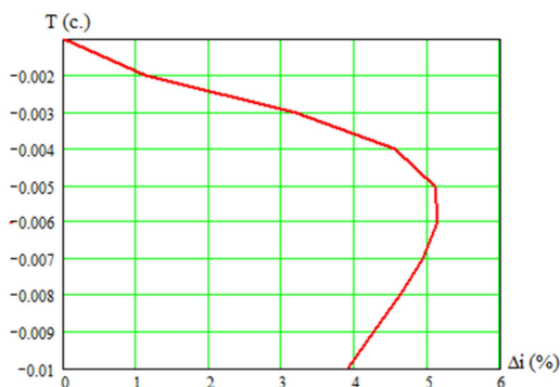
Рис. 3. Зависимость погрешности в вычислении текущего значения тока от постоянной времени сети (интервал дискретизации – 0,625 мс.)
