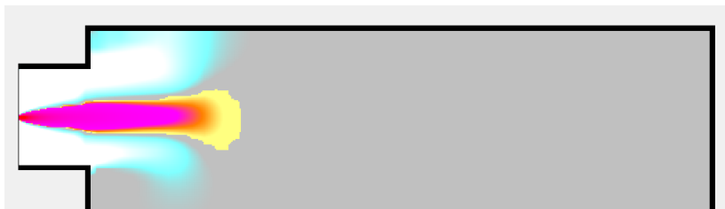
Рис. 4. Вид сверху на диффузионный факел в стекловаренной печи с подковообразным движением газов
