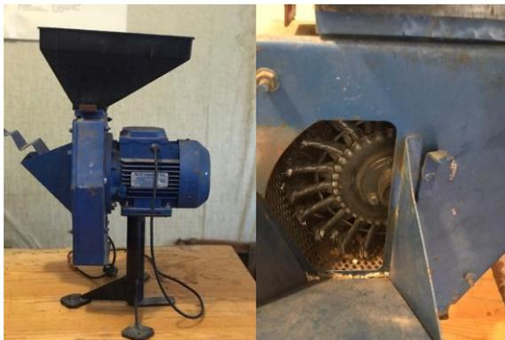
**Рис. 1. Экспериментальная установка с иглофрезерными рабочими органами**
