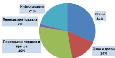
**Рис. 3. Структура потерь теплоты в здании**
