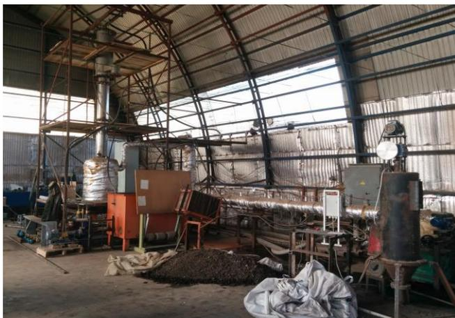
**Рис. 2. Опытно-промышленный технологический модуль низкотемпературного термолиза**
