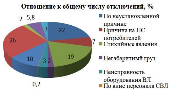
Рис. 1. Диаграмма процентного соотношения причин отключений воздушных ЛЭП в период с 2002 по 2016 г.
