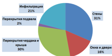
Рис. 3. Структура потерь теплоты в здании
