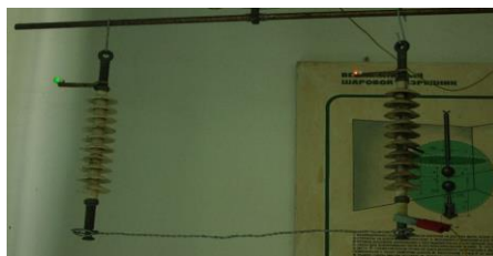
Рис. 3. Изображение дефектного и исправного полимерных изоляторов с установленными на них светодиодными индикаторами
