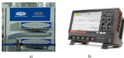
Рис. 1. Внешний вид цифровых средств диагностики: а) без визуализации текущих процессов; б) с визуализацией
