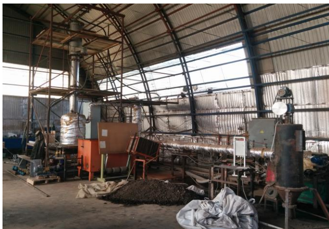
Рис. 2. Опытно-промышленный технологический модуль низкотемпературного термолиза
